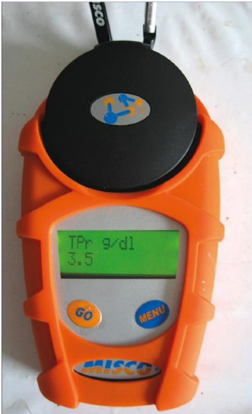
Hodnocení celkové bílkoviny (CB) v digitálním refraktometru (hodnota CB 3,5 g/dl = 35 g/l séra je hluboce pod referenční hodnotou 55 g CB na 1 l séra)
